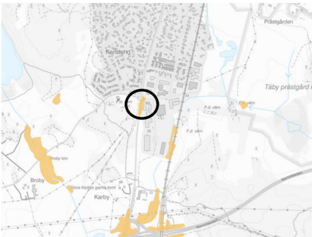
Figur 13. Kartunderlag för förutsättningar för skred i finkornig jordart. Utredningsområdet markeras med svart cirkel. Karta från SGU.
