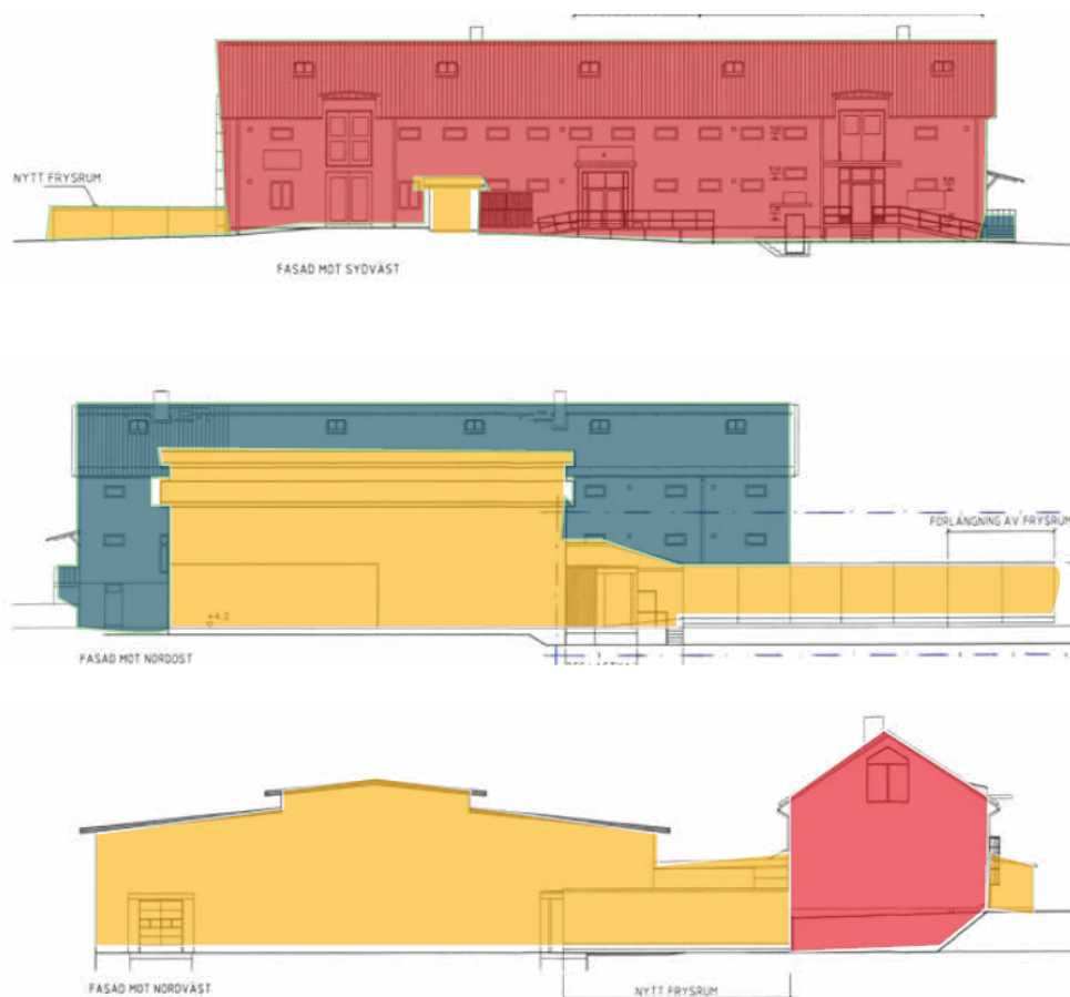
Figur 17. Känslighetsanalys av Tygförrådet ur kulturmiljösynpunkt. Röd färg indikerar hög känslighet (södra fasaden, gavlar), blågrön färg känslighet (norra fasaden) och gul färg tålighet (nyare tillbyggnader). Bild: Tengbom.
