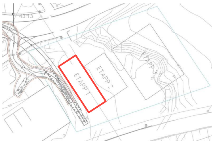
Figur 2 Transformatorstationen som nu byggs är ETAPP 1, varefter ETAPP 2 byggs till. I framtiden byggs ETAPP 3, varvid ETAPP 1 och ETAPP 2 kommer att rivas.
